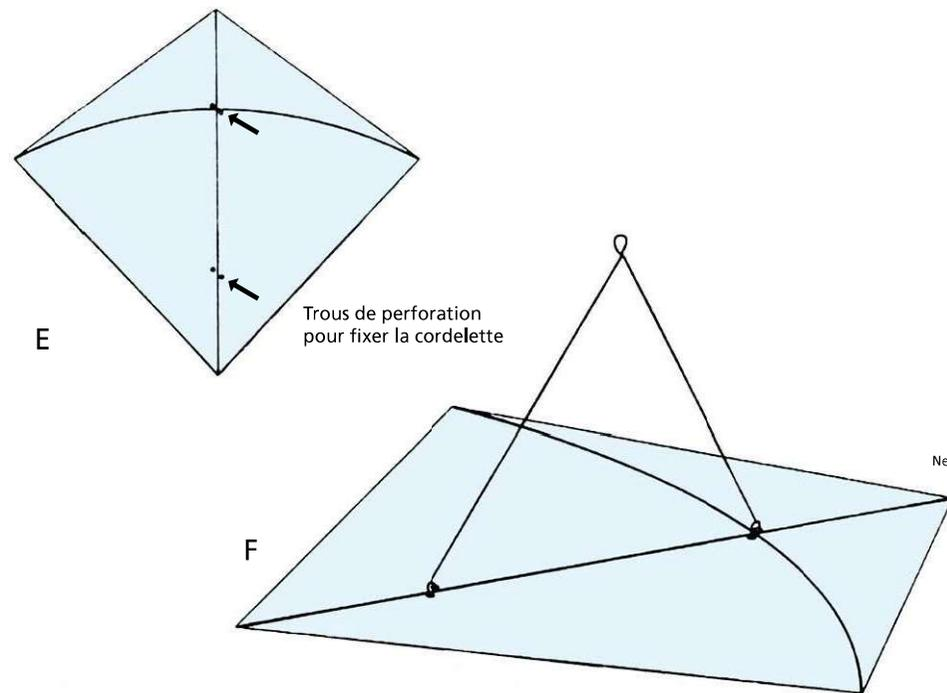
courber pour la fixer à l'extrémité de l'aile droite. Le croisement des deux baguettes doit correspondre exactement au point d'attache supérieur (D).
